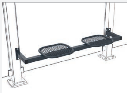
Bänk U-2022 Två robusta sittplatser i trådnät utan ryggstöd. Gallermått 1 500 mm. Varmförzinkad och pulverlackerad enligt RAL. De är monterade på baldakinens stolpar.
